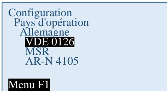
Sélectionner la directive d'injection dans le réseau en vigueur à l'aide des touches « **^** » et « **v** ».
