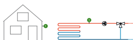
Système avec chauffage de surface, régulation du circuit de chauffage en fonction de la température extérieure
