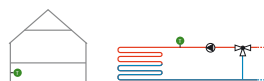
Système avec chauffage de surface, régulation du circuit de chauffage en fonction de la température ambiante
