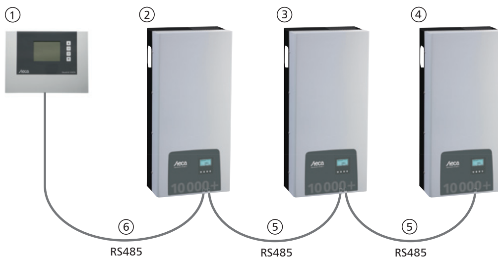
Abb. 6: Verkabelungsschema, dargestellt am Beispiel der Fernanzeige StecaGrid Vision
