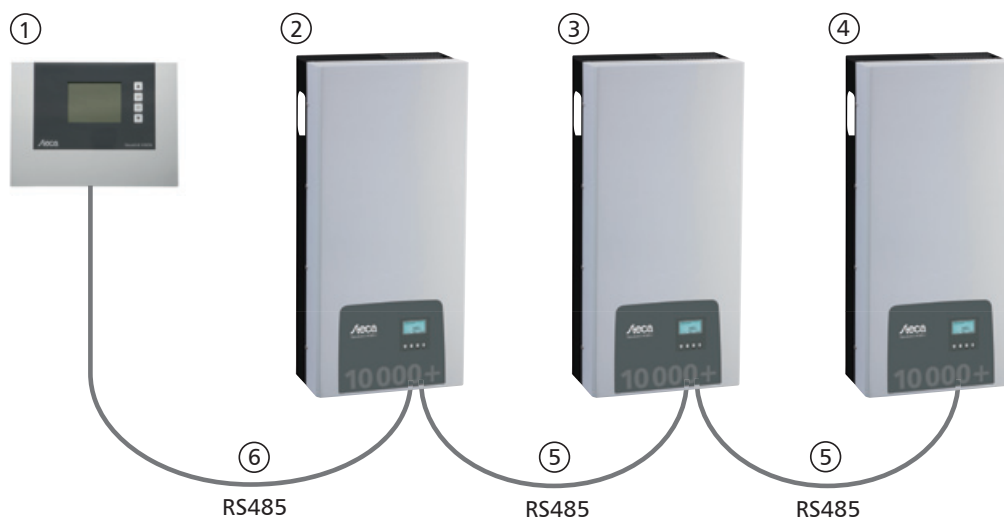
Fig. 6: Exemple de schéma de câblage pour le système de téléaffichage StecaGrid Vision
